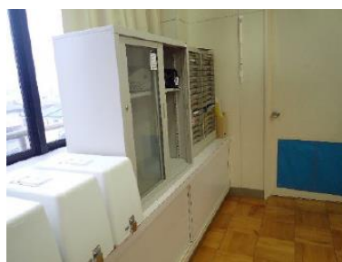
写真2 積み重ねられ固定されていない棚
